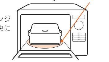
※回転タイプの電子レンジは必ずレンジ皿の中央にのせてください。
