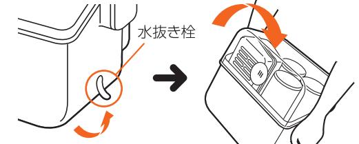
水を抜いた後、水抜き栓を閉めてください。
