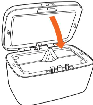
上フタは中央部を押して、しっかり閉じてください。スライドプレートが片側のみ上がっている場合は、再度スライドプレートを下方向に止まるまで押し込み、上フタの中央部を押して閉めてください。
