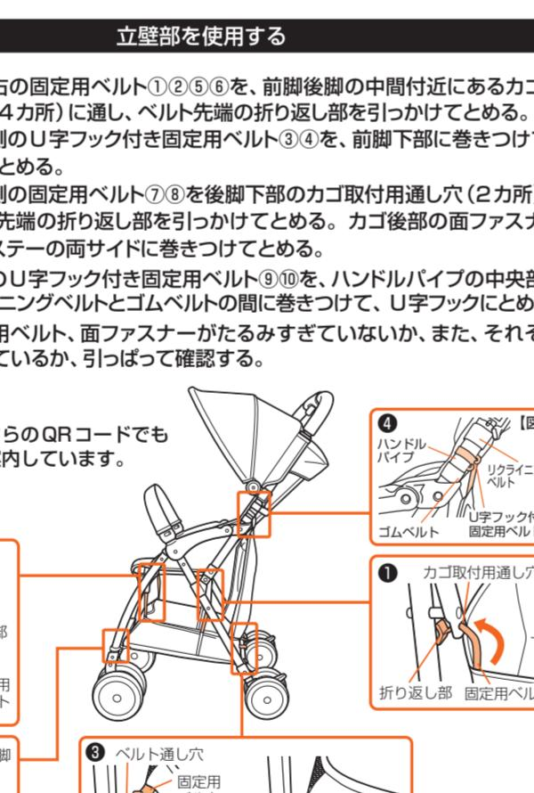
1. 立壁部を使用する取り付け方法①②③の手順に従い固定用ベルト①～⑩及び面ファスナー⑪⑫を取り付ける。
