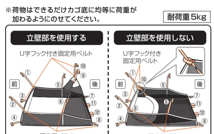
1. 立壁部を使用する取り付け方法①②③の手順に従い固定用ベルト①～⑩及び面ファスナー⑪⑫を取り付ける。
