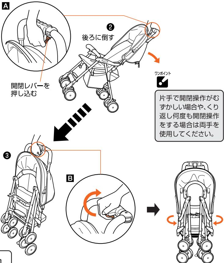
3. 図③の状態から図Bのように手元部分を上方向に回転すると折りたためます。このとき、手元部分が回転したら赤い開閉レバーは押し込まないでください。赤い開閉レバーを押し込んだままでは自動フックがかかりません。開閉レバーをはずし自動フックがかかったかをご確認ください。
