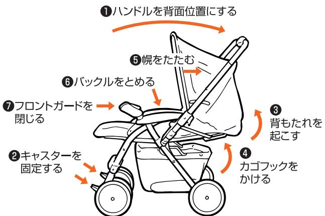
まず、ベビーカーの後ろに立って、ハンドル中央部の手元ロックボタンを右にずらします。赤いステッカーが表示されます。
