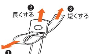
●長さ調整のときに差し込みバックルを取りはずした場合は、下図のとおりに確実に取り付けてください。
