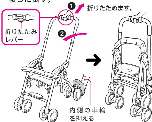
折りたたみレバーを握りながら、後車輪を支点にして矢印②のように後方に倒す方法でも折りたためます。
