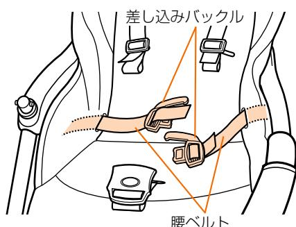
**7. 肩ベルトを差し込みバックルの肩ベルトフック(左右)にひっかける。**
