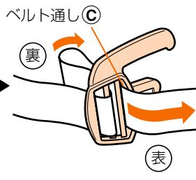
4. バックル表側にある腰ベルトを、ベルト通し④から裏側に通す。(ベルト通し④には腰ベルトが2重に通ります)
