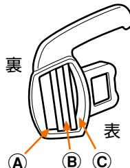
**注意** 差し込みバックルへの取り付けかたが、不完全ですと、使用中にベルトが抜けるおそれがあります。確実に取り付けられていることを確認してから、使用してください。
