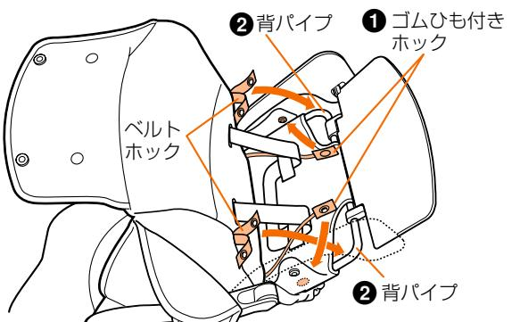
4. ①着脱シート両側のホック(4カ所)をベースシートにとめ、**a**をサイドプレートの角**b**にかぶせる。
