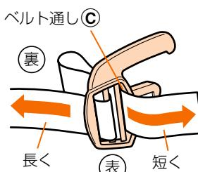
3. バックル表側にある腰ベルトを、ベルト通し①から裏側に通す。
