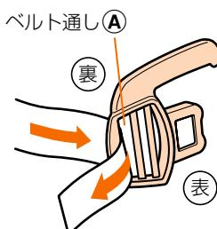
2. バックル表側にある腰ベルトを、ベルト通し②から裏側に通す。
