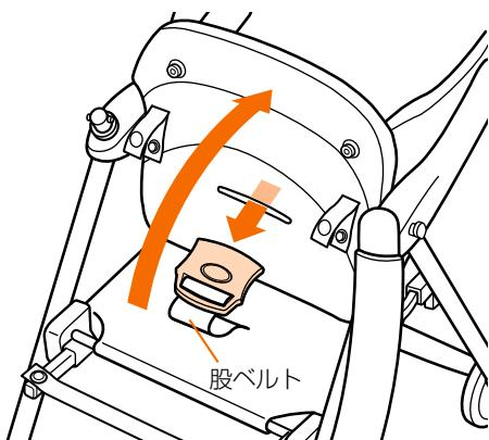
6. ①着脱シートの上部カバーのホック(2カ所)をはずし、②着脱シート両側のホック(4カ所)をベースシートからはずす。
