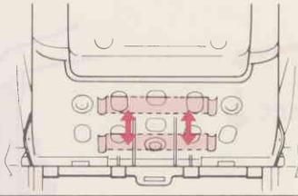
万一、股ベルトをはずした場合は、腰ベルトから差し込みバックルをはずした場合は、図①②のように確実にセットしてください。
