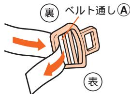
2. バックル表側にある腰ベルトを、ベルト通し②から裏側に通します。
