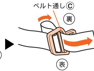
4. バックル表側にある腰ベルトを、ベルト通し④から裏側に通します。(ベルト通し④には腰ベルトが2重に通ります)
