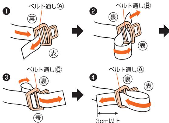
※腰ベルトの長さは、ベルトの端が3cm以上残るように調節してください。
