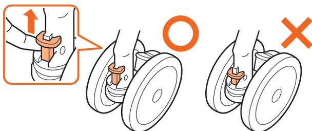
図B 押す人側のストッパーの▲印がキャスターロックレバーと向きあい、キャスターが確実にロックされていることを確認
