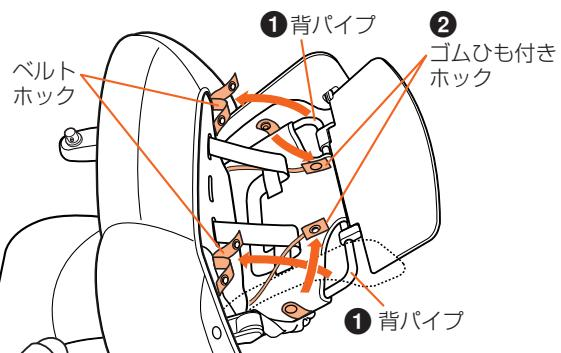
8 腰ベルトと肩ベルトを引き抜き、着脱シートをベースシートからはずす。
