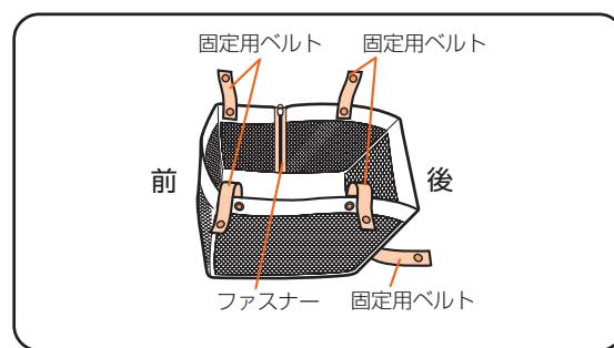
1 カゴの前部にある2ヵ所の固定用ベルトを、車体下部の左右にあるアルミフレームにホックでとめる。
