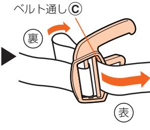
4 バックル表側にある腰ベルトを、ベルト通し④から裏側に通す。(ベルト通し④には腰ベルトが2重に通ります)
