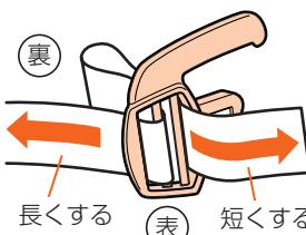
3 バックル表側にある腰ベルトを、ベルト通しAから裏側に通す。
