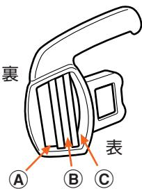
1 バックル裏側にある腰ベルトを、ベルト通しAからはずす。
