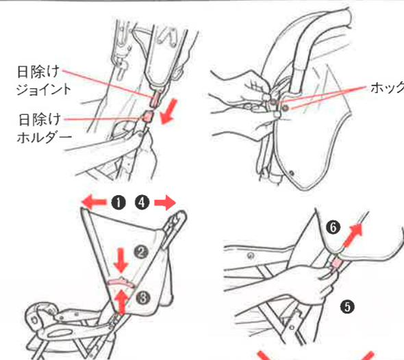
使用するときは①日除けを前にひろげ、②日除けレバーの関節部を押し下げてください。
