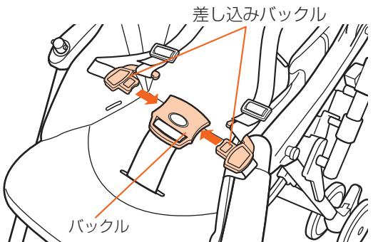
6 左右の差し込みバックルに腰ベルトを取り付ける
