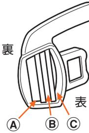
1 バックル裏側にある腰ベルトを、ベルト通し(A)からはずす。
