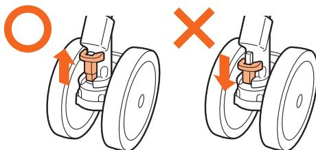
図B 押す人側のストッパーの▲印がキャスター ロック レバーと向き合い、キャスターが確実にロックされていることを確認
