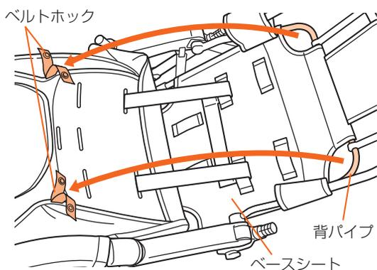
6. 側面のフレームとベースシート下部の背パイプにとめてあるホック(左右2カ所ずつ)をはずす。
