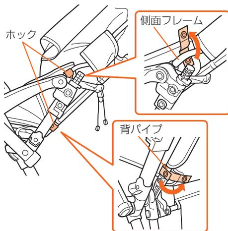
7. 腰バックルと肩バックルを引き抜き、着脱シートをベースシートからはずす。
