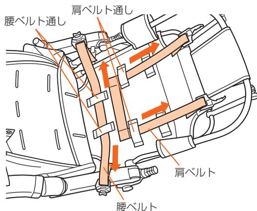
2. 着脱シートのベルト通し穴に腰バックルと肩バックルを通し、着脱シートの表側にベルトの先端を引き出す。
