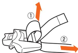
肩・腰ベルトの長さは、ベルトの端が3cm以上残るように調節してください。使用中に肩・腰ベルトが抜けて、お子さまが落ちるおそれがあります。取り付け後、肩・腰ベルトを強く引っ張り、それぞれのバックルから抜けないことを確認してください。
