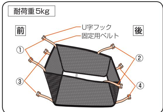
1. カゴについている8カ所の固定用ベルト①②③④をフレームホルダーまたは前・後脚フレームに巻きつけて、固定用ベルト先端にあるU字フックにしっかりと通す。
