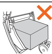
※荷物はできるだけカゴ底に均等に荷重が加わるようにのせてください。耐荷重5kgは、ポケット部も含めた耐荷重です。ポケット部耐荷重:500gまでです。
