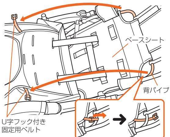
**7. 側面のフレームとベースシート下部の背パイプにとめてあるホック(左右2カ所ずつ)をはずす。**
