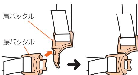
3. 股バックルを引き出し、股バックルの左右に重ねた肩と腰バックルを差し込み、「カチッ」と音がすることを確認する。
