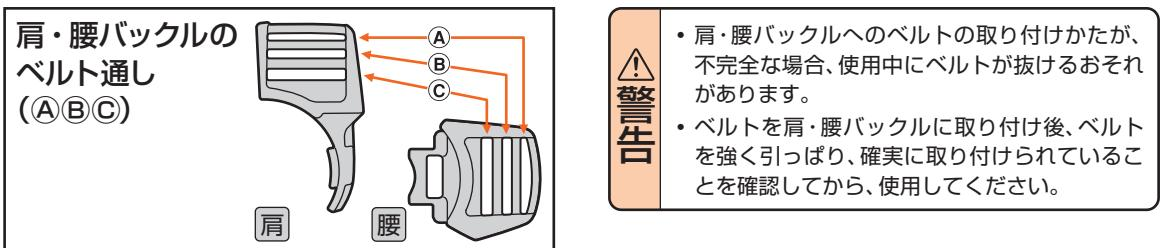
1. バックルのベルト通し③にベルトを通し、ベルト通し①にベルトを通す。
