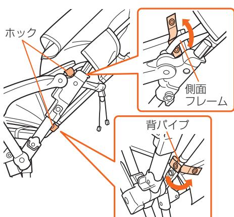
**8. 腰バックルと肩バックルを引き抜き、着脱シートをベースシートからはずす。**
