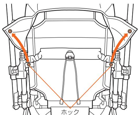
6. 側面のフレームとベースシート下部の背パイプにとめてあるホック(左右2カ所ずつ)をはずす。
