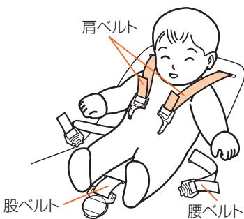
3. 股バックルを引き出し、股バックルの左右に重ねた肩と腰バックルを差し込み、「カチッ」と音がすることを確認する。
