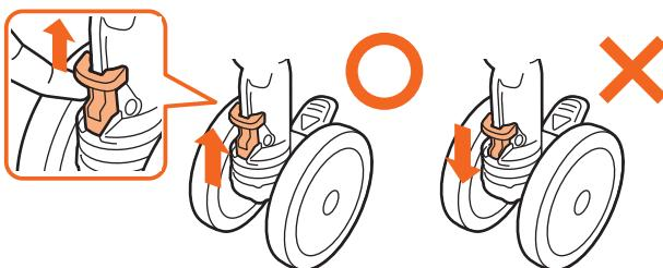
図B 押す人側のストッパーの▲印がキャスターロックレバーと向きあい、キャスターが確実にロックされていることを確認
