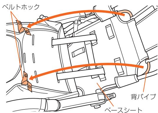
7. 腰バックルと肩バックルを引き抜き、着脱シートをベースシートからはずす。
