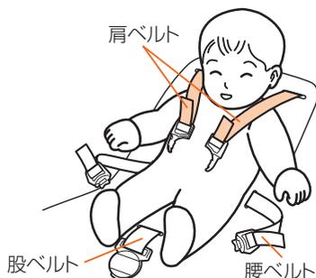
3. 股バックルを引き出し、股バックルの左右に重ねた肩と腰バックルを差し込み、「カチッ」と音がすることを確認する。
