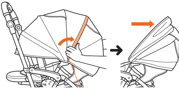
後幌フレームの根元部分を両手で持ち動かします。
