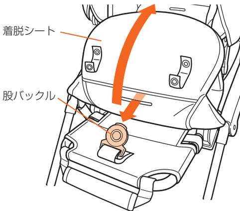
6. 着脱シートのベルトホック(2カ所)をベースシートの固定ループからはずす。
