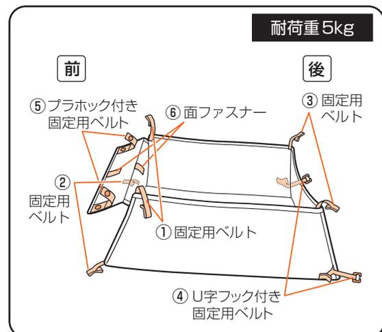
1. ① カゴ前上部の固定用ベルト①を前脚中央のベルト通し穴に外側から通してとめる。
