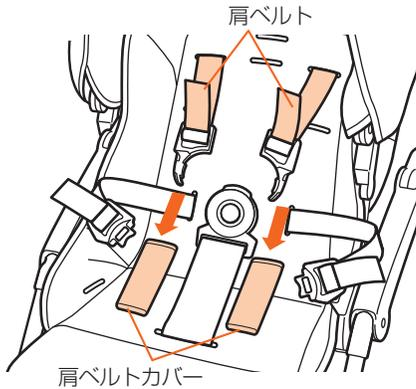
4. シートフレームにとめてある座面裏側のベルトホック(2カ所)をはずす。
