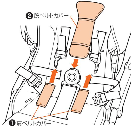
8. ベルト連結カバーのゴムベルトに肩・腰ベルトを通す。
