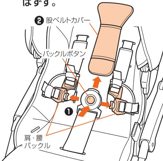
2. ベルト連結カバーのゴムベルトから肩・腰ベルトを矢印方向に引き抜き、ベルト連結カバーをはずす。
