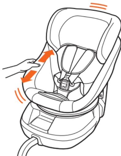
回転およびリクライニング操作後には、レバーが「カチッ」と音がして、元の位置に戻り、シートがロックされていることを確認してください。シートがロックされていない状態で使用しないでください。
