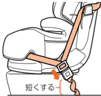
ワンポイント ● バックルの付け根のベルトに1~3回ひねりを加えてもしっかり固定できない場合は、当社専用のフィットマット(別売)をご使用ください。
