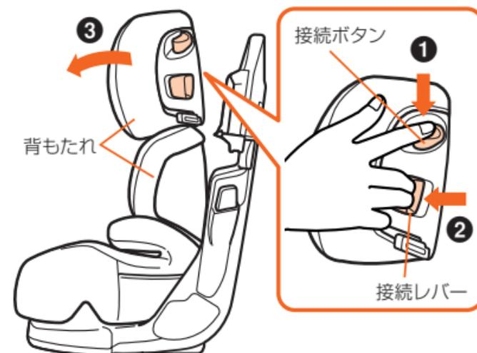
**ワンポイント** ●接続ボタンと接続レバーを操作するときは、サイドサポートを閉じた状態で行うと操作がしやすくなります。
