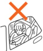
●車両座席形状によって、チャイルドシートの背もたれが、車両ヘッドレストにぶつかり回転操作できない場合があります。その状態のままで、無理に回転させないでください。故障の原因になります。
