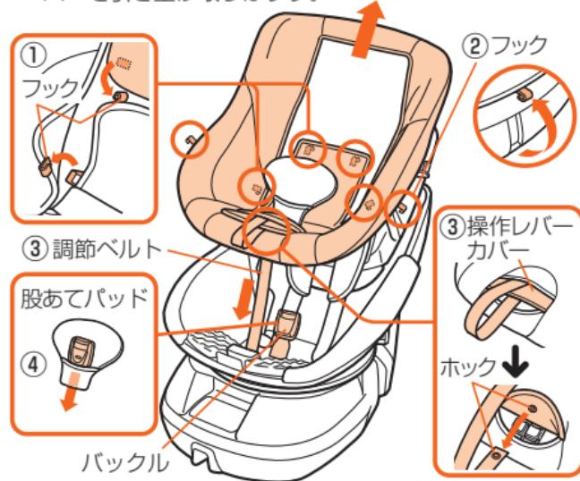
※ヘッドレストから幌を取りはずしてから、カバーを取りはずします。(26ページ「幌の取りはずしかた」参照)
