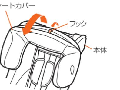
3 エッグショックパッドをシートカバー上部裏側のヘッドサポートポケット内側にあるエッグショックパッド収納ポケットに付け替える。
