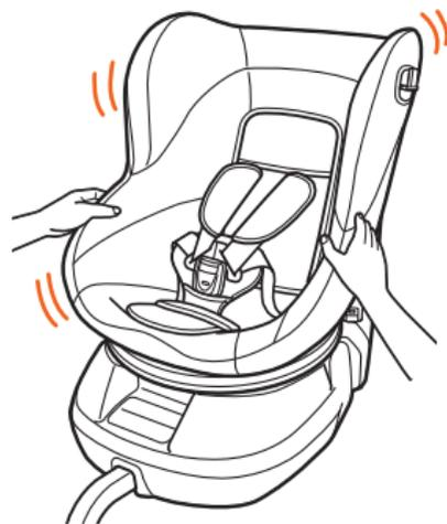
「回転」および「リクライニング」操作後には、レバーが「カチッ」と音がして、元の位置に戻り、シート部がロックされていることを確認してください。シート部がロックされていない状態で使用しないでください。
