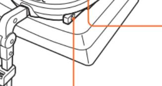
回転 / リクライニングのレバーが正規の位置に戻っていて、シート部が確実に固定されていること
