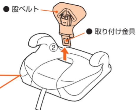
\*取り付けの場合は、取り付け金具を本体の穴にタテに差し込む。
