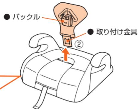
\*取り付けの場合は、取り付け金具を本体の穴にタテに差し込む。
