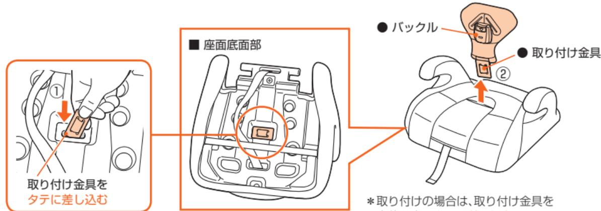
\* 取り付けの場合は、取り付け金具を本体の穴にタテに差し込む。
