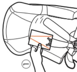
車の座席の背もたれがリクライニングできる場合、チャイルドモード、ジュニアモードでご使用のときは、本製品の背もたれを15°前後に傾けて取り付けます。
