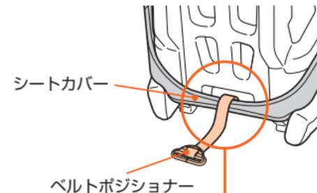
●ベルトポジションナーが、シートカバーと本体の間を通るように取り付けてください。
