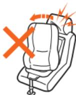
●調節ベルトが操作レバーカバー裏にあるホックに固定されていない状態で使用しないでください。ベルトが首に巻き付き、窒息するおそれがあります。
