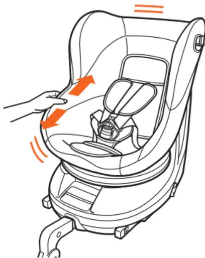
「回転」および「リクライニング」操作後には、レバーが「カチッ」と音がして、元の位置に戻り、シート部がロックされていることを確認してください。シート部がロックされていない状態で使用しないでください。
