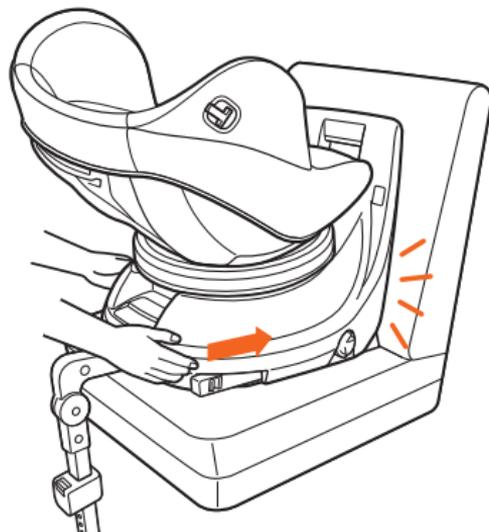
車種によっては、しっかり押し込んでも本体背面と車両背もたれとの間にすき間が生じる場合があります。車両背もたれがリクライニングできる場合はできるだけすき間が小さくなるよう、リクライニング角度を調節してください。
