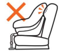
※車両ヘッドレストが取りはずせる場合は、取りはずすことで操作が可能になればその座席でも取り付けできます。
