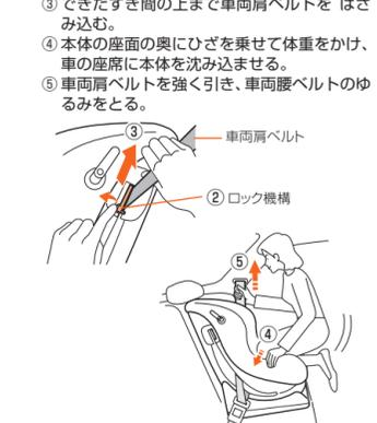
4 ①車両肩ベルトを強く引いたまま、②ロック機構を押し込み閉める。
