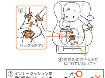
2 左右の差込タンクを組み合わせてから「カチッ」と音がするまで、差込タンクをバックルに差し込む。
