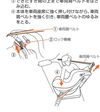
4 ①車両肩ベルトを強く引いたまま、②ベルトガイドにはさみ込む。③ロック機構を押し込み閉める。
