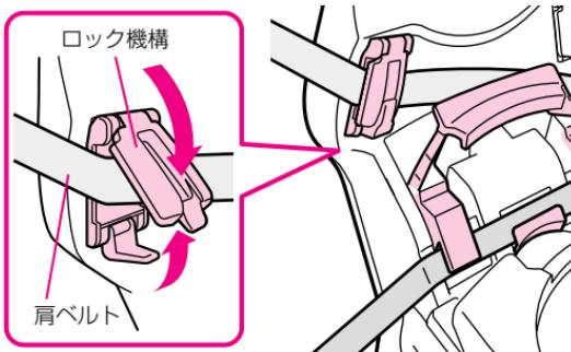
ロック機構は左右2カ所ありますが、使用するのは、**車のバックルと反対側のロック機構**だけです。
