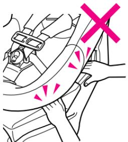
**2** リクライニングレバーを上げたまま、ベース部とリクライニング部の回転位置表示がそろう位置まで座席部を押し込むようにして起こします。
