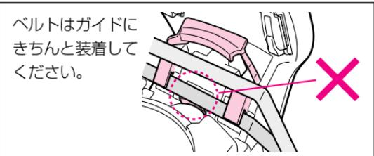
**7** シートベルト通し部内の車のシートベルト(肩ベルト)を、肩ベルトガイドに装着します。
