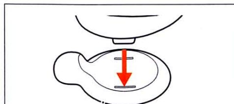
お皿のセットは、お皿の裏にある凸部を受け台の凹部のみぞにあわせて確実に差込み固定してご使用ください。
