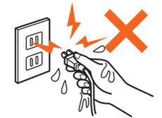
差し込みプラグを抜く時は電源コードを持って引かないでください。また、電源コードの上に重い物をのせたりしないでください。電源コードが破損し感電・火災のおそれがあります。
