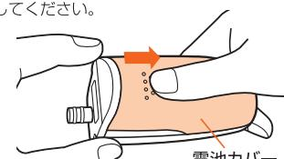
2 図のように、新しい単3アルカリ乾電池2本を電池ケース内部の表示にあわせて正しく入れる。
