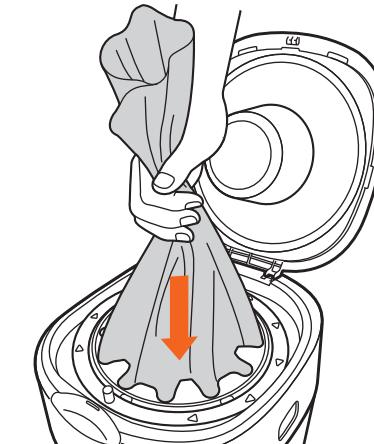
6 押し下げたフィルムの端を結び、結び目をフタ裏側のフックにかける。
