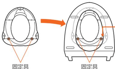
補助便座を大人用便座に前合わせで取り付けの際に、固定具と便座横幅の隙間が少し空くくらいが目安です。
