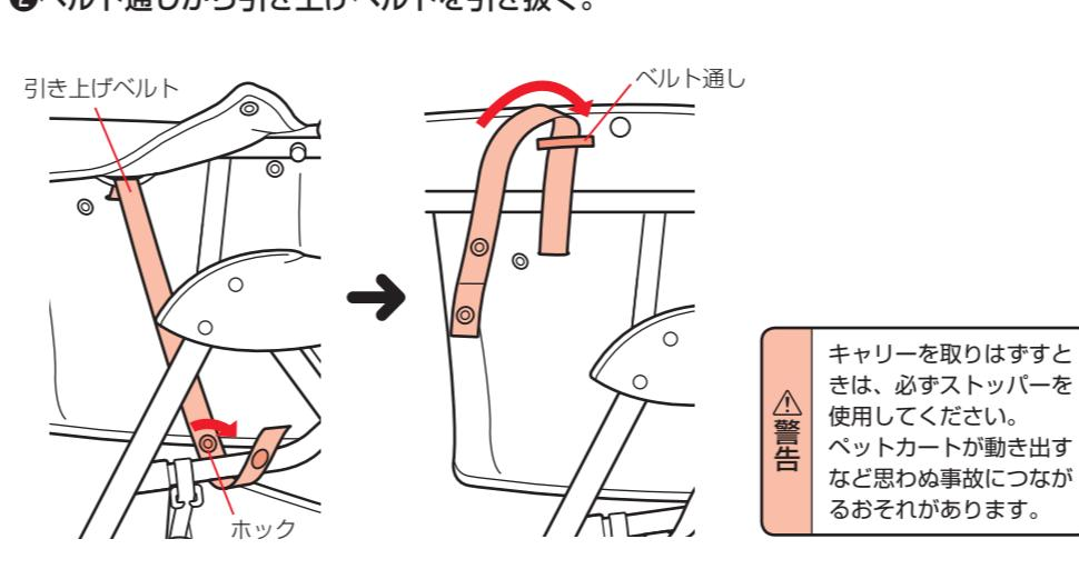
4. サポートフレーム後部先端をサポートフレーム用ループ(4カ所)から引き抜き、キャリーを取りはずす。
