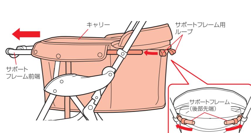
1. サポートフレームの外側からベルト通しに、引き上げベルトを通し。
