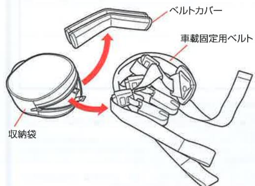
2. ベルトカバーを左右のベルトに巻き付け、面ファスナーでとめる
