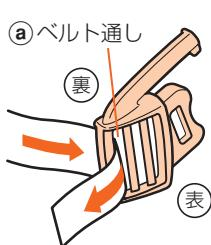
2. バックル表側から、ベルト先端を②ベルト通しを通して、裏側へ入れる。
