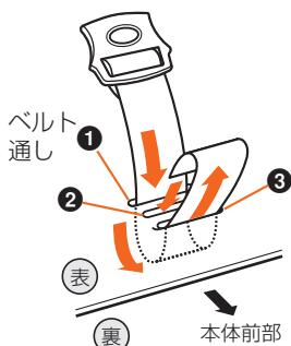
2. ベルト先端を①ベルト通しから表側に戻す。
