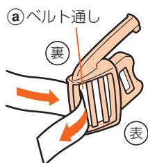
2. バックル表側から、ベルト先端を②ベルト通しを通して、裏側へ入れる。
