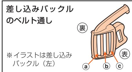
1. バックル裏側から、腰ベルトを①ベルト通しを通して、表側へ引き出す。
