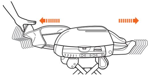
**4** サイドガード下のスウィングロックレバーを引き出して、ロックを解除する。
