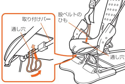
2. 引き出したひもの輪に、バックルと股ベルトを通して、固定する。
