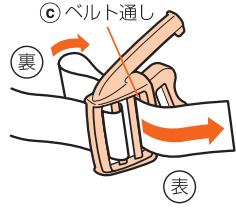
2. バックル表側から、ベルト先端を②ベルト通しを通して、裏側へ入れる。
