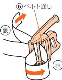
4. ベルト先端を④ベルト通しを通して、裏側へ入れる。
