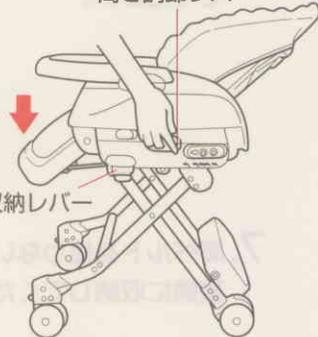
3. 左右の収納レバーを指でつかみ、①上へ持ち上げるようにしてから②外側へレバーをゆっくり解除してください。
