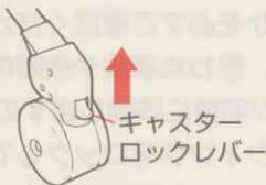
②固定する場合は、キャスターロックレバーを下げ車輪を回転させて図の位置にすると、固定されます。
