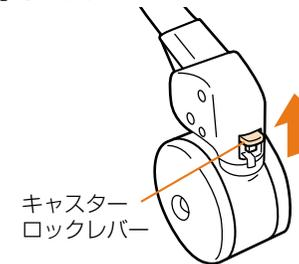
※キャスターの動きは、高さ調節の段階により異なります。動きが悪い場合は、高さ調節を最上段にしてください。
